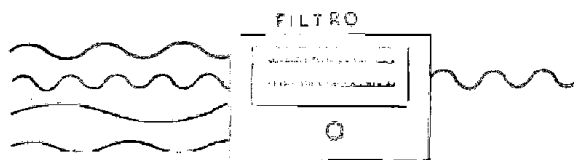
Fig. 2.2. - Un filtro è posto all'entrata di qualsiasi apparecchio radio. Ad esso giungono molte onde radio, ma ne lascia passare una sola.
